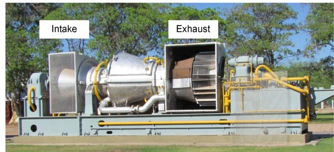
Fig. 13. 17 MW gas/diesel turbine used by Generación Riojana
