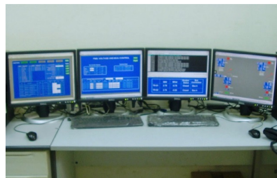
Figura 7. Estaciones de visión remota utilizadas en toda la planta MOH para permitir la visualización y el diagnóstico continuos de todo el sistema.
