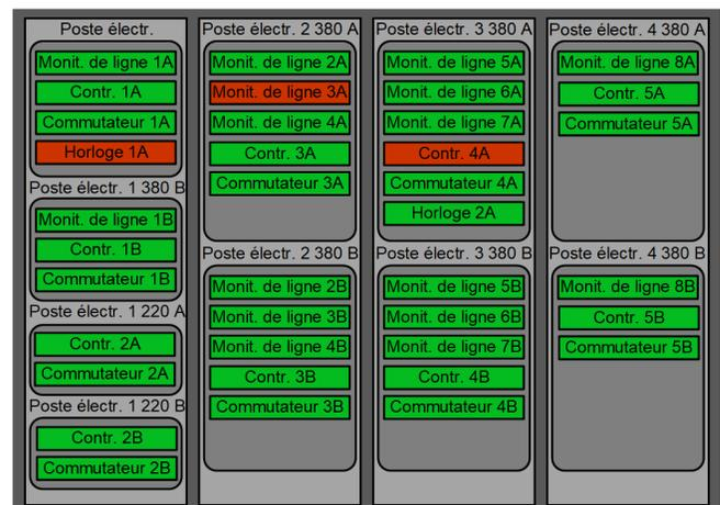
Fig. 10. Écran de surveillance de l'état du dispositif du SPS
