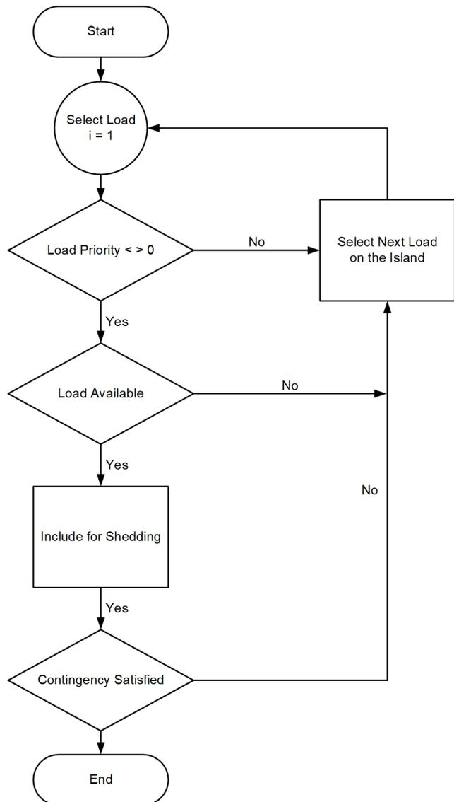
Fig. 5. Load-Selection Logic
