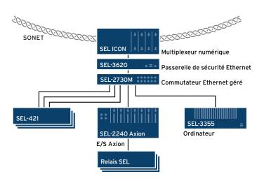
Dans cet exemple de réseau de poste électrique, le SEL-2730M prend en charge l'accès technique, le système SCADA, les synchrophaseurs ainsi que de nombreux autres services dans des configurations faciles à utiliser.
