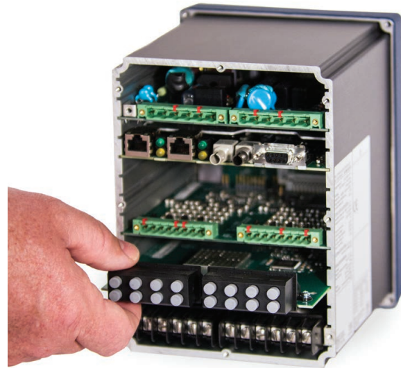
Commander quatre ou huit entrées de capteur d'arc électrique.
