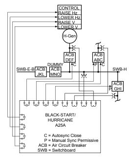
Fig. 2 Platform 1 Black-Start/Hurricane Generator A25A
