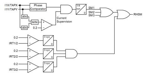
Fig. 8. HSM Reset Logic
