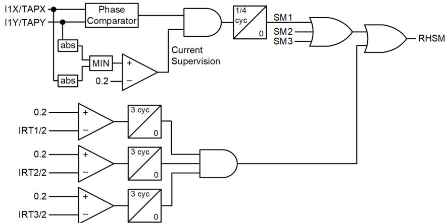
Fig. 8. HSM Reset Logic
