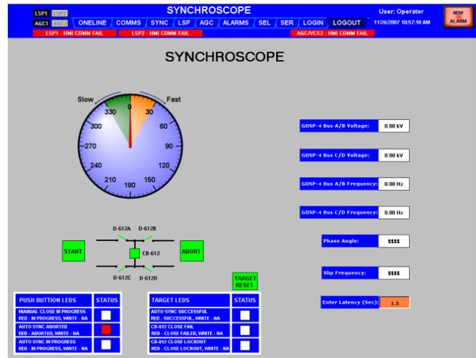
Fig. 8. Automatic Synchronizer
