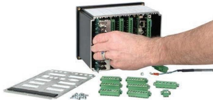
Обмен или расширение карт ввода/вывода в **SEL-2411P** реализуется просто. Необходимо лишь отсоединить разъемы и снять заднюю крышку.
