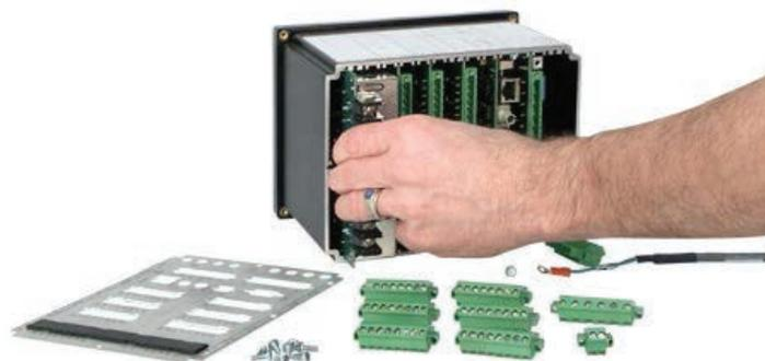
O SEL-2411P facilita a troca ou expansão de cartões de I/Os. Basta desconectar os conectores e remover a tampa traseira.
