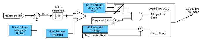
Fig. 3 Progressive Overload-Shedding Logic
