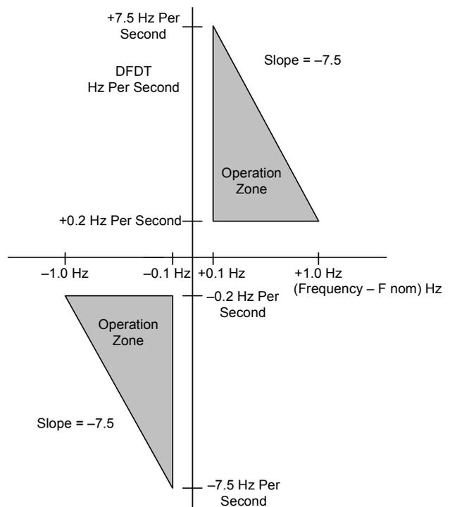
Fig. 6. Fast DFDT Logic
