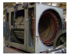
Fig. 28. 14,000 hp ID fan motor
