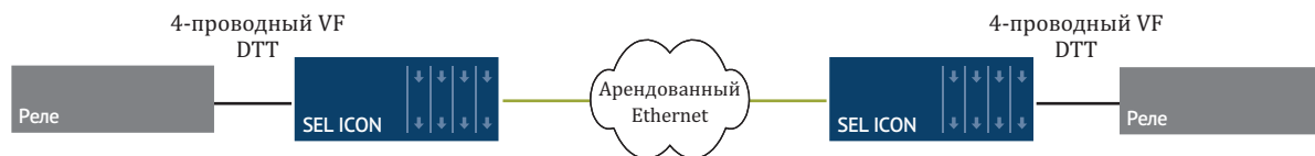
Рисунок 7 Переход с аналоговых каналов DTT на арендованную сеть Ethernet
