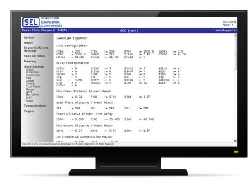
Um servidor da web integrado fornece fácil acesso aos ajustes, status do relé, medição e dados de eventos.
