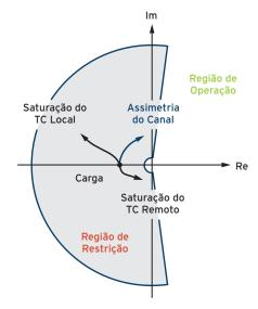
Acomodação da assimetria do canal e saturação do TC através das regiões de operação e restrição no Plano Alfa.
