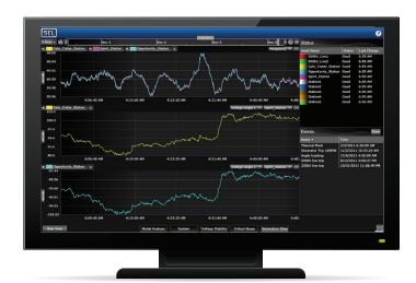
Le logiciel SYNCHROWAVE SEL-5078-2 Central permet la visualisation et l'analyse des conditions de fonctionnement du réseau électrique.
