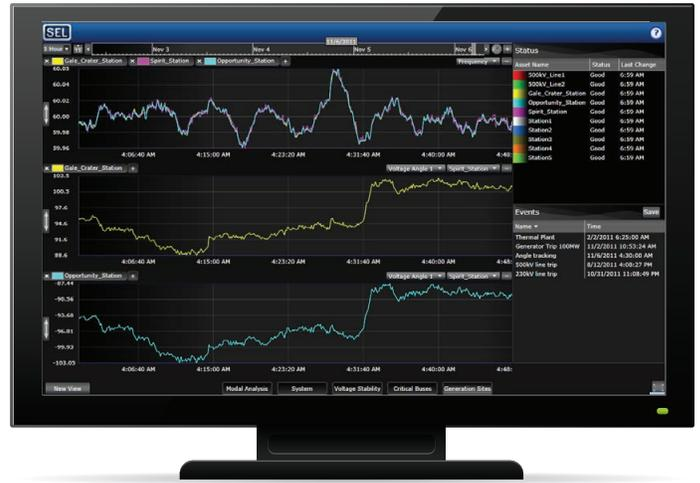
El software SEL-5078-2 SYNCHROWAVE Central proporciona visualización y análisis de las condiciones de funcionamiento del sistema de potencia.
