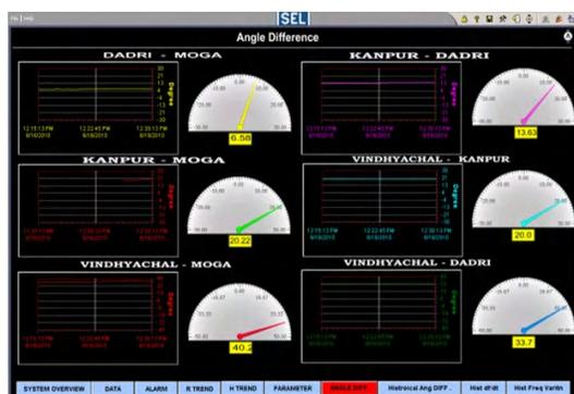
Рисунок 3. Измерения угла напряжения между подстанциями
