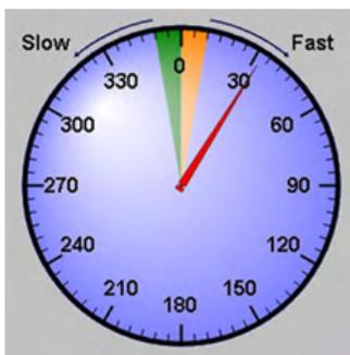
Fig. 13. Autosynchronizer display
