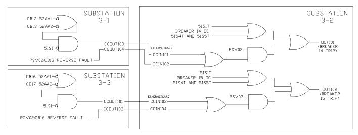
Fig. 10. Breaker Trip Logic
