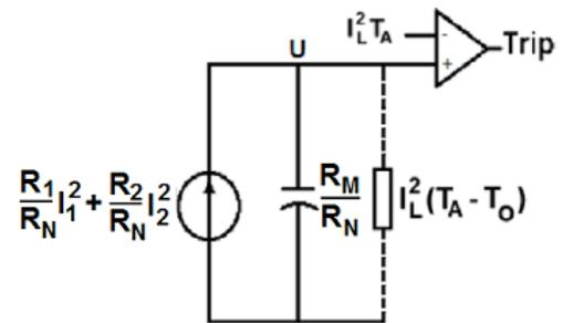
Fig. 5 Rotor Thermal Model
