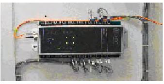
Fig. 6. Digital I/O Module
