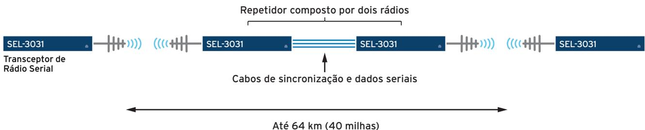
É possível conectar os rádios SEL-3031 "de ponto a ponto" para criar um repetidor. A configuração do repetidor pode estender o alcance de um link ou manter contato de rádio quando houver um obstáculo entre duas subestações.
