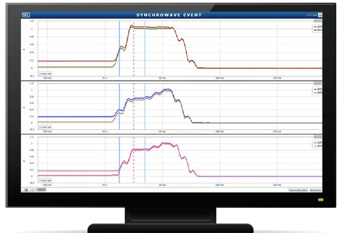
Программное обеспечение SYNCHROWAVE Event отображает значения рабочих токов и токов торможения для трех разных зон защиты.
