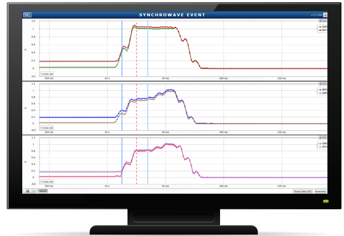
O Software synchroWAVE EVENT exibe correntes individuais de operação e restrição para três zonas de proteção diferentes.
