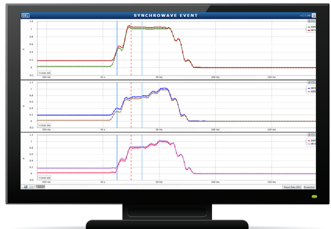
El software SYNCHROWAVE Event muestra las corrientes de operación y restricción individuales para las tres diferentes zonas de protección.
