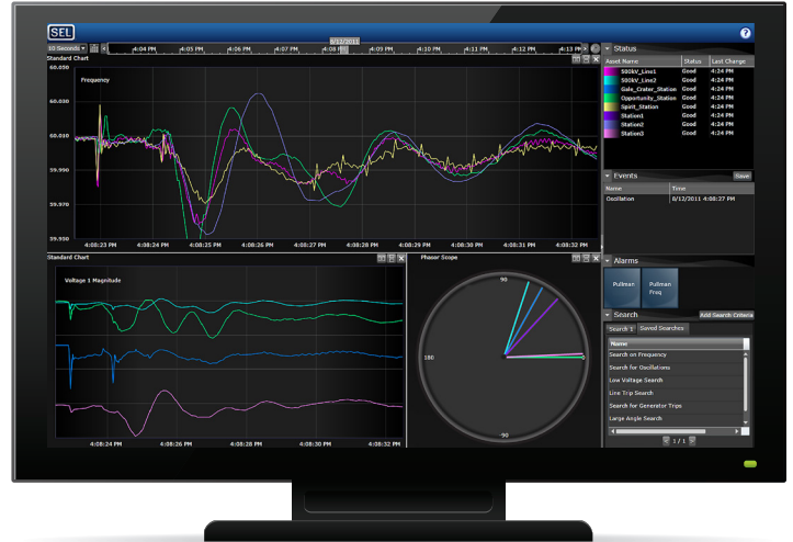
Le SEL-487E dépasse la norme IEEE C37.118 avec jusqu'à 50 messages par seconde à 50 Hz ou jusqu'à 60 messages par seconde à 60 Hz.
