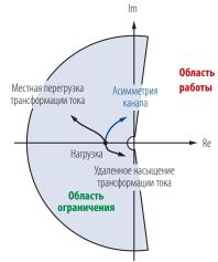
Отрегулируйте асимметрию каналов и насыщение трансформатора тока.
