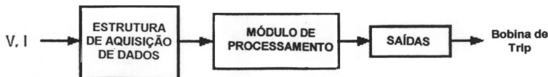
Figura 11: Diagrama de Blocos Funcional de um Relé Digital
