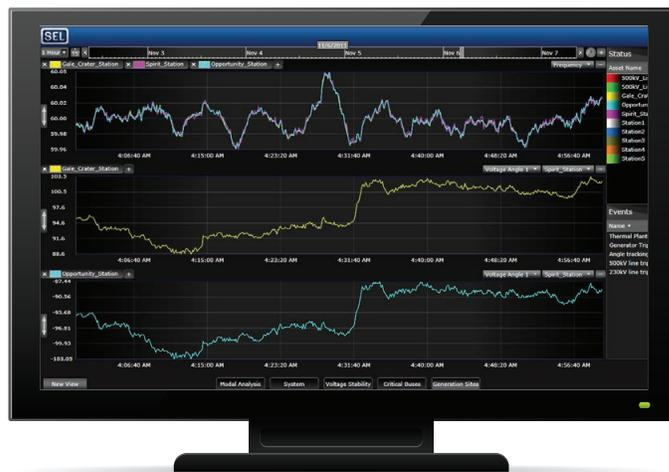
ПО synchroWAVE Central Software дает возможность визуализировать и проводить анализ условий работы системы.
