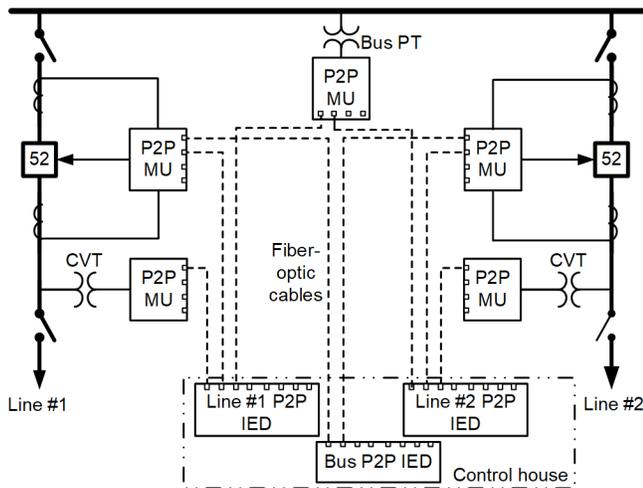
Fig. 2. A simple substation utilizing P2P DSS.
