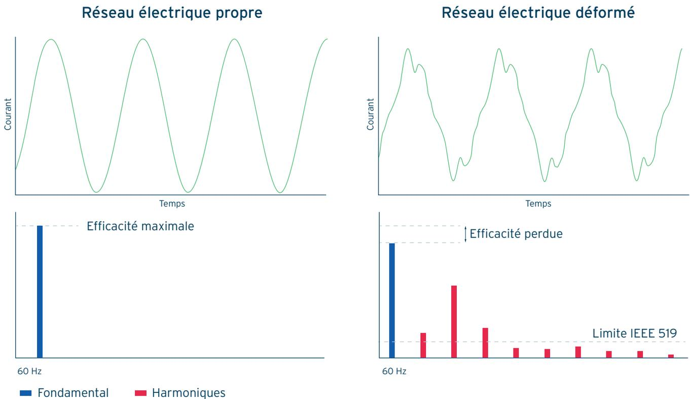
Une forme d'onde sinusoïdale pure garantit le transfert d'énergie le plus efficace, car elle ne contient que la fréquence fondamentale.
