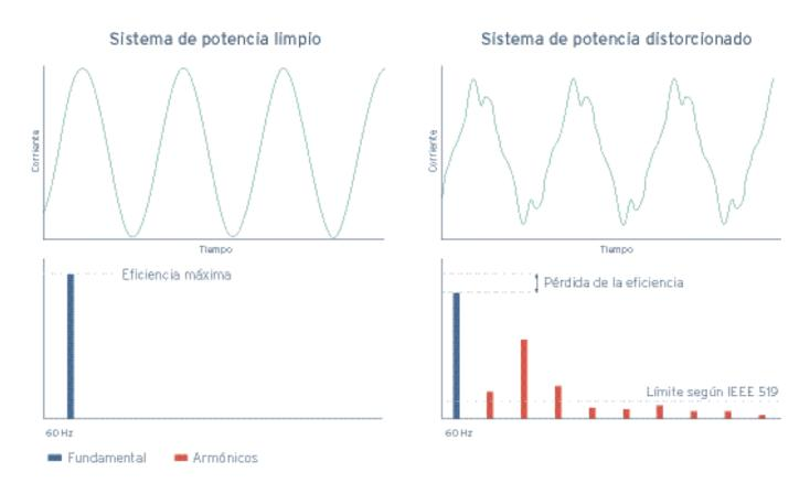
La transferencia de energía más eficiente se da con una forma de onda sinusoidal pura, ya que solamente contiene la frecuencia principal.
