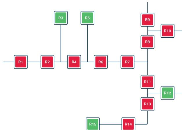
O HDC da SEL simplifica o esquema de proteção, permitindo que praticamente qualquer quantidade de religadores opere seletivamente com margens de coordenação.
