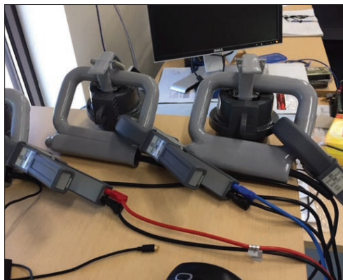
Figura 4 — Loops de corrente MCL120 conectados aos transmissores SEL-FT50 no laboratório de teste.
