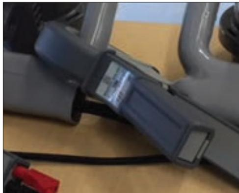
Figura 4 — Los circuitos de corriente MCL120 conectados a los transmisores SEL-FT50 en el laboratorio de pruebas.
