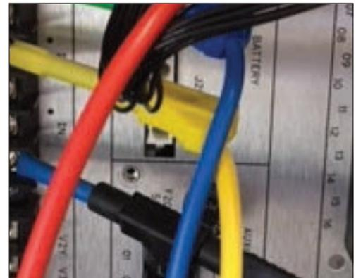
Figura 5 — El TC conectado a las entradas de corriente del SEL-651R en el laboratorio de pruebas.
