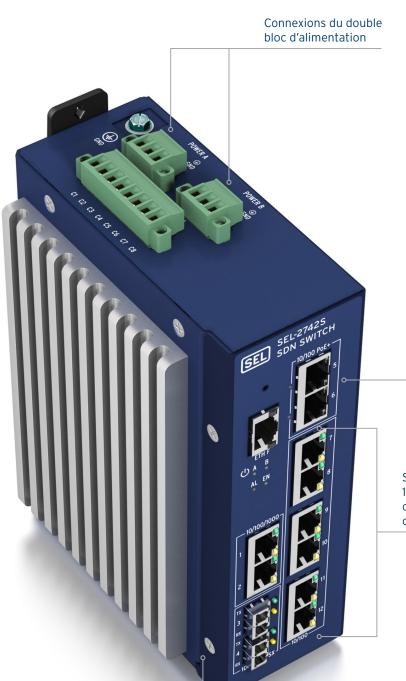
Deux ports 10/100BASE-T pour l'alimentation électrique par Ethernet mise à
