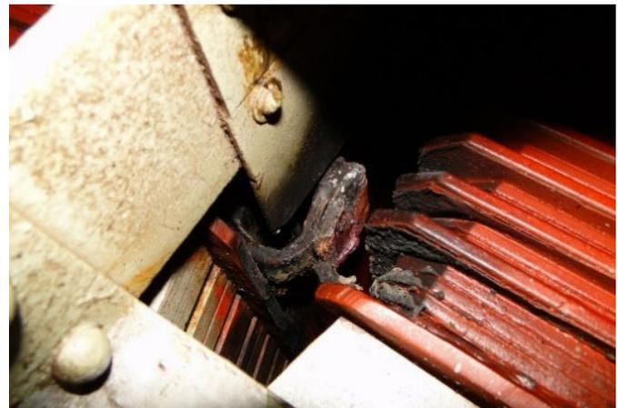
Fig. 26. Condição LOF Resultante de um Enrolamento de Campo em Circuito Aberto.
