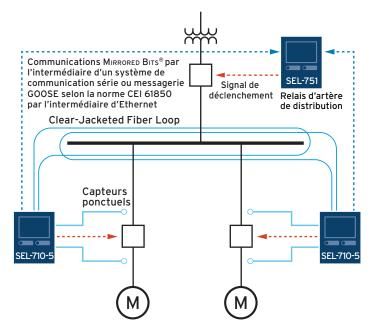
L'association de la détection des arcs électriques contrôlée par surintensité à un système de communications avancées permet une amélioration de la sécurité et de la fiabilité du système électrique.
