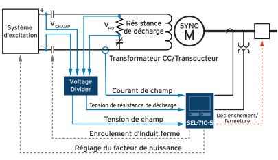
Dans cette application de moteur synchrone de type à balais, le SEL-710-5 se connecte directement au système d'excitation pour régler le facteur de puissance.
