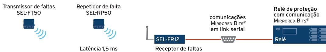
Latência total com 1 repetidor de falha = 1,5 ms para SEL-RP50 + 6 ms para SEL-FT50/SEL-FR12
