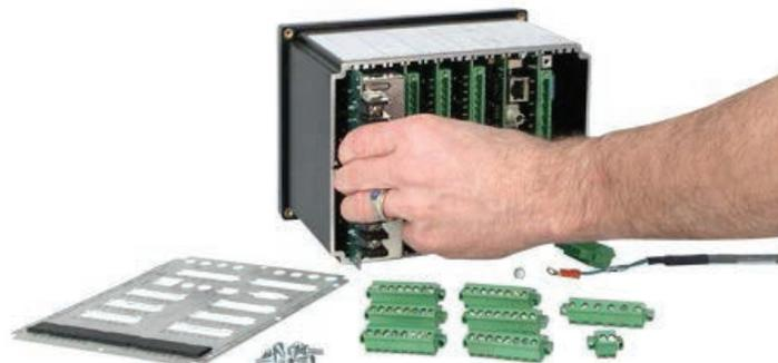
El SEL-2411P facilita el intercambio o la expansión de tarjetas de E/S. Solo tiene que desacoplar los conectores y retirar la cubierta posterior.
