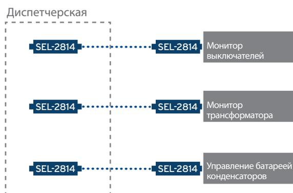
Передача информации между удаленным оборудованием и пунктом управления возможна даже на самых крупных станциях.
