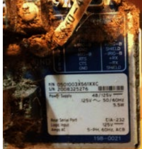
Рисунок 3. Реле SEL-501, выдержавшее торнадо EF5
