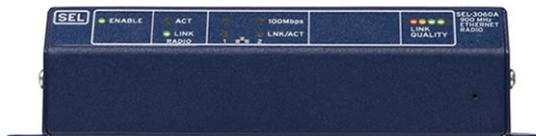
EL SEL-3060 A, tiene una tasa de transmisión de datos de 1 Mbps, está fabricado para operación de -40 grados a 85 grados, excede IEEE 1613, IEEE C37.90 e IEC 60255, consume menos de 4 watts y tiene un rango de 24 km en modo punto a punto y 16 km en modo punto a multipunto.
