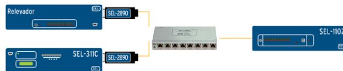
Figura 2. Relés con el SEL-2890 en la red Ethernet
