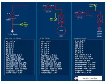
Fig. 11. Metering Detail Screen
