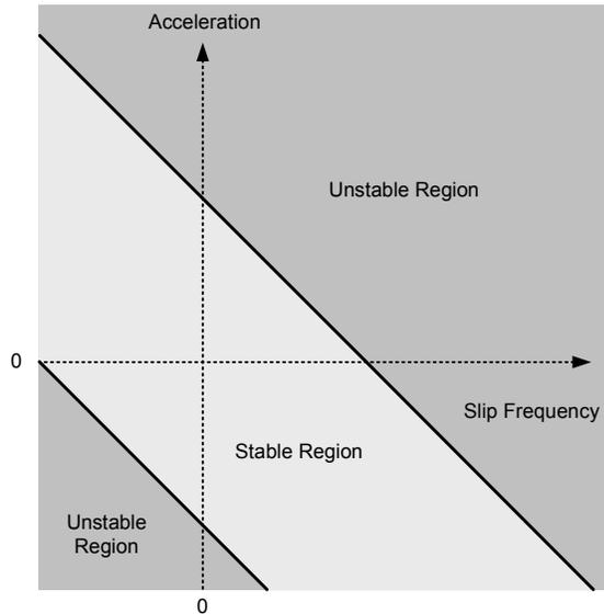
Fig. 14. Out-of-Step Detection
