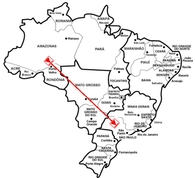
Fig. 1. Linhas de transmissão HVDC de 600 kV bipolares com 2400 km interligam a subestação retificadora de Porto Velho com a subestação inversora de Araraquara
